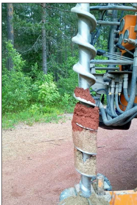
2021-06-14. Skruvborr i provpunkt 2 i löparbanan, nivån 0-0,5 meter under markytan. Det röda materialet är rödfyr, under vilken det fanns sandfyllning.
