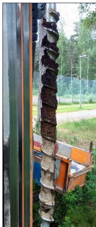
2021-06-14. Skruvborr i provpunkt GV1, där grundvattenrör installerades. Nivå 0-1 meter under markytan. Den översta halvmetern var sandig humus med inslag av torv, under det påträffades den på området allmänt förekommande ljusa gulvitgrå siltiga sanden.
